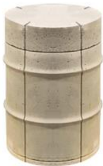
Betonmantel – Rund- und Axialschnittlinien
