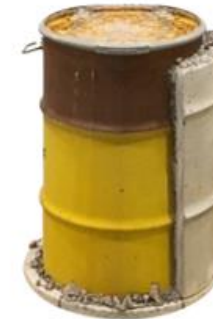
Entfernung des Betonmantels
